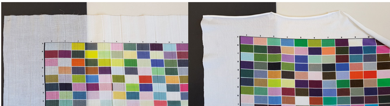
Vergleich von Textilien mit geringer (links) und hoher Opazität.
